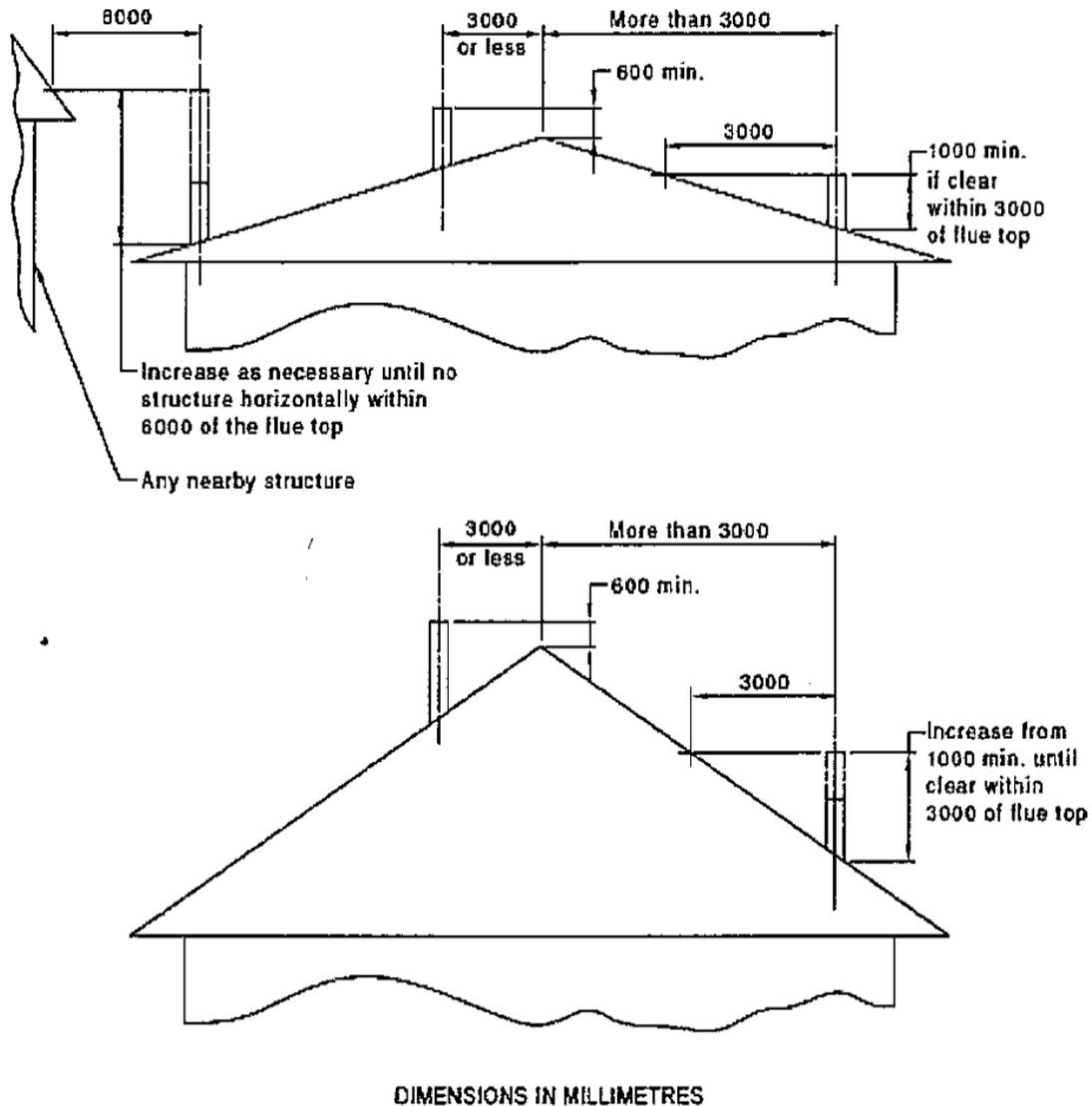
FIGURE 4.8 MINIMUM HEIGHT OF FLUE SYSTEM EXIT
